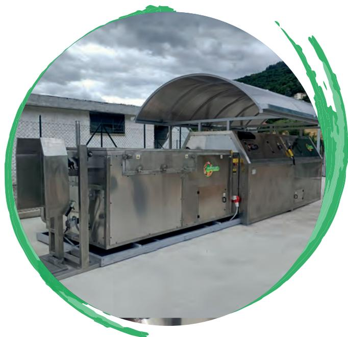
**ELEKTROMECHANISCHER KOMPOSTER MODELL KCE MIT INTEGRIERTEM TRAGEBEHÄLTER VON 3 M<sup>3</sup>, WIEGESYSTEM FÜR DAS ENTLADEN VON FAHRZEUGEN MIT BECKEN, FASSWENDER UND FREISTEHENDER GEWÖLBTER ÜBERDACHUNG**
