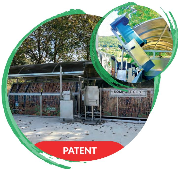
ELEKTROMECHANISCHE KOMPOSTIERUNGSANLAGE MIT AEROBISCHEM ZYKLUS, MODELL KCE, MIT LADEBEHÄLTER VON 3/5 M<sup>3</sup>, WIEGESYSTEM UND VERTIKALER SCHNECKE FÜR DIE ZUFÜHRUNG VON SAMMELFAHRZEUGEN.
